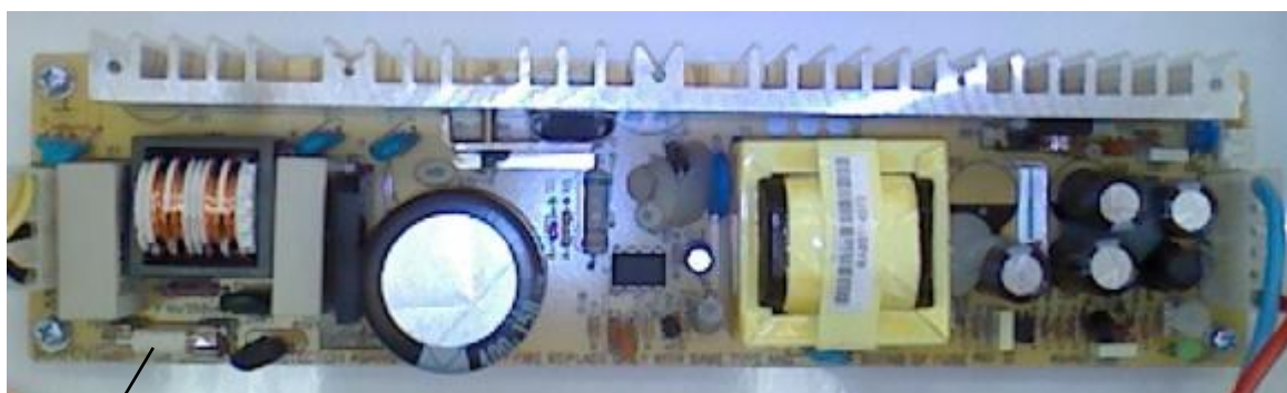
Вставка плавкая ВП2Б-1В 4 А/ 250 В
